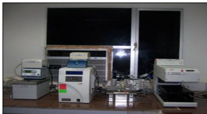
FIG. 1: FRANZ DIFFUSION APPARATUS
