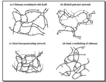
FIG.7. STRUCTURE OF CHITOSAN HYDROGELS FORMED BY (a) CHITOSAN CROSS-LINKED WITH IT SELF; (b) HYBRID POLYMER NETWORK; (c) SEMI-INTERPENETRATING NETWORK; (d) IONIC CROSSLINKING
